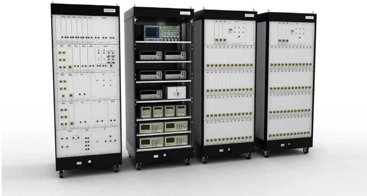
Автоматизированная система контроля энергопреобразующей аппаратуры (АСК ЭПА) предназначена для проведения автоматизированных испытаний энергопреобразующей аппаратуры системы электропитания космического аппарата.
