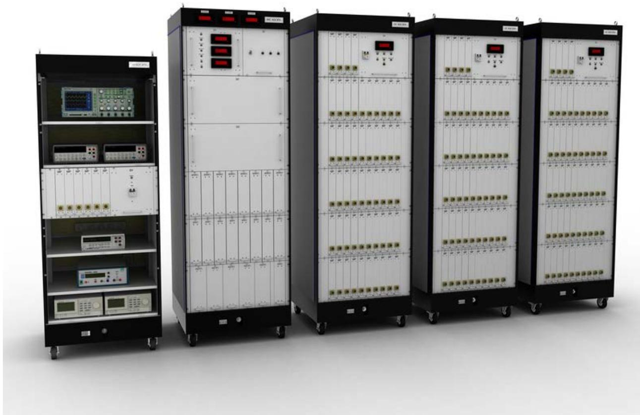
Автоматизированная система контроля энергопреобразующей аппаратуры (АСК ЭПА) предназначена для проведения автоматизированных испытаний энергопреобразующей аппаратуры системы электропитания космического аппарата.
