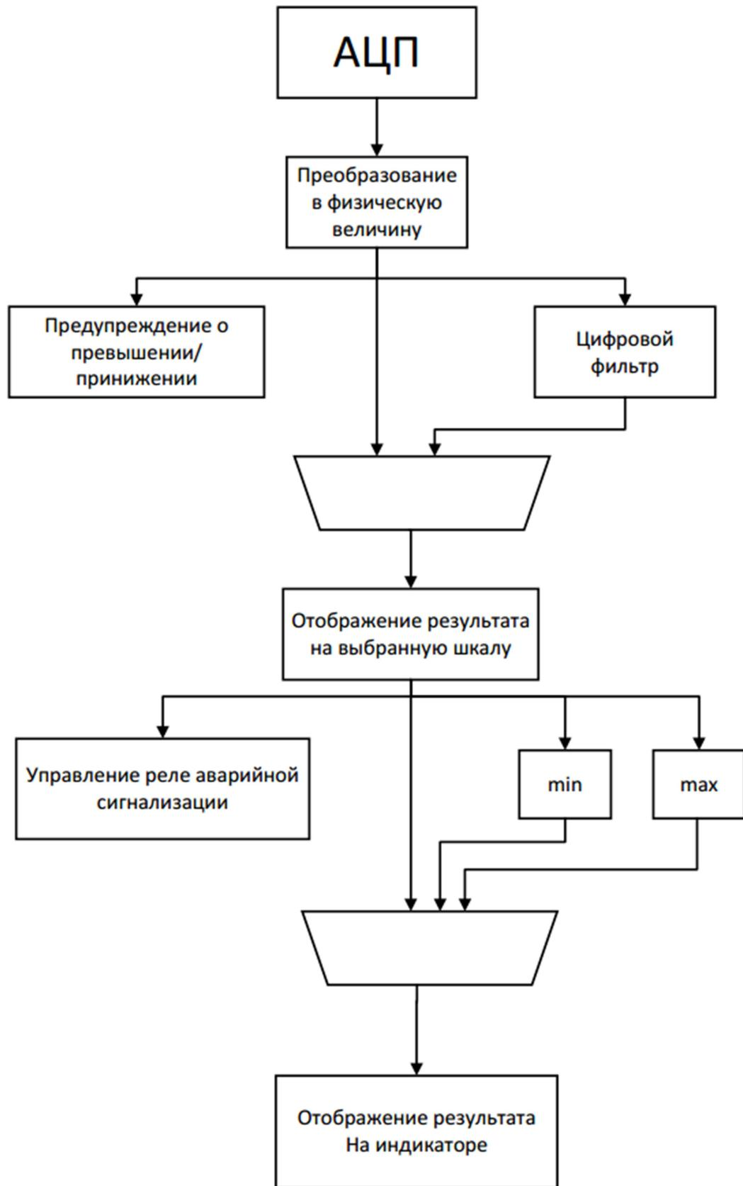
Рисунок 2.1 – Последовательность обработки и отображения результатов измерений
