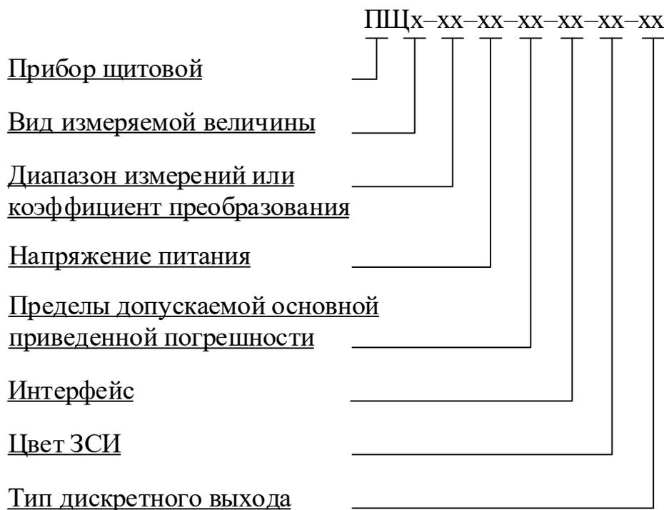
**Вид измеряемой величины:** А – постоянный ток, В – напряжение постоянного тока.
