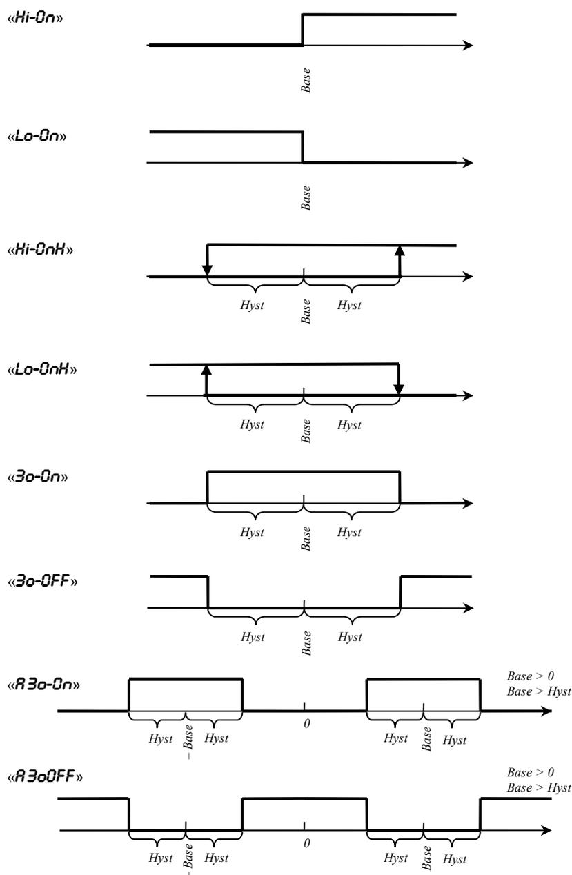
Рисунок Ж.2 – Способы управления реле аварийной сигнализации
